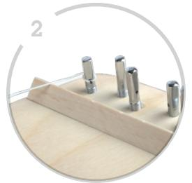
Enrosque a corda através do orifício na cavilha de afinamento. Dobre a corda após inseri-la pela cavilha de afinamento, para a manter no respectivo lugar.
