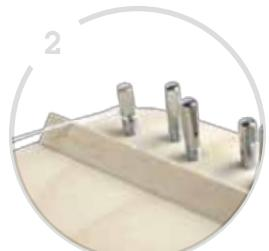
Enfilez la nouvelle corde à travers le trou de la cheville. Pliez la corde après l'avoir insérée à travers la cheville pour la maintenir en place.
