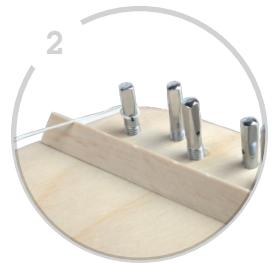
Fädeln Sie die neuen Saiten durch das Loch im Stimmwirbel. Biegen Sie anschließend den überstehenden Teil der Saite entgegen der Drehrichtung des Wirbels ab, um ihn zu fixieren.
